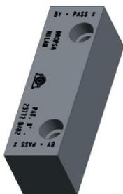
El elemento de by-pass tiene las mismas dimensiones que un elemento dosificador pero sin pistón interno, es decir, sin dosificación. Su función es crear una posición de reserva donde se pueda instalar una válvula dosificadora para aumentar el número de salidas.
